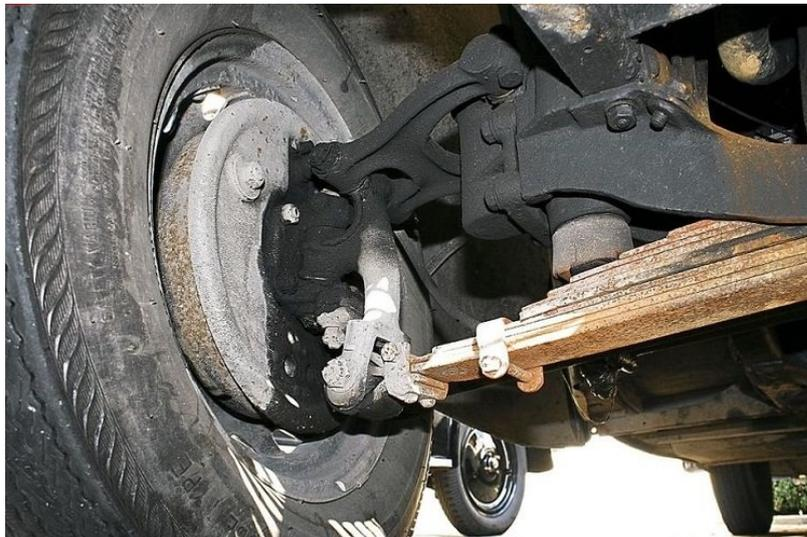
Рис. 8. Грузовой автомобиль с зависимой подвеской на поперечных рессорах
