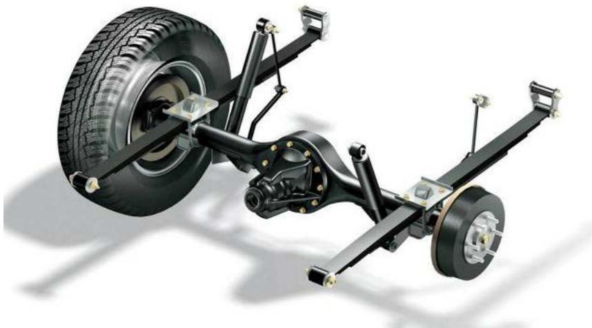
Рис. 9. Схема зависимой подвески на продольных рессорах
