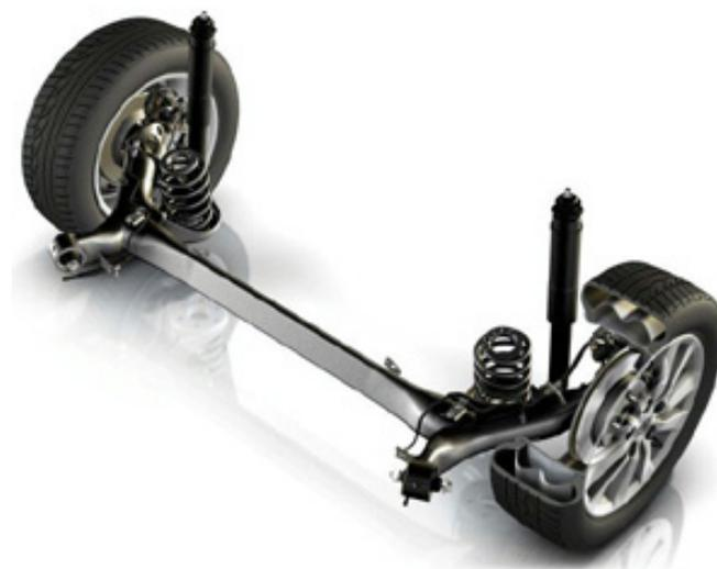
Рис. 6. Торсионно-рычажная (полузависимая)
